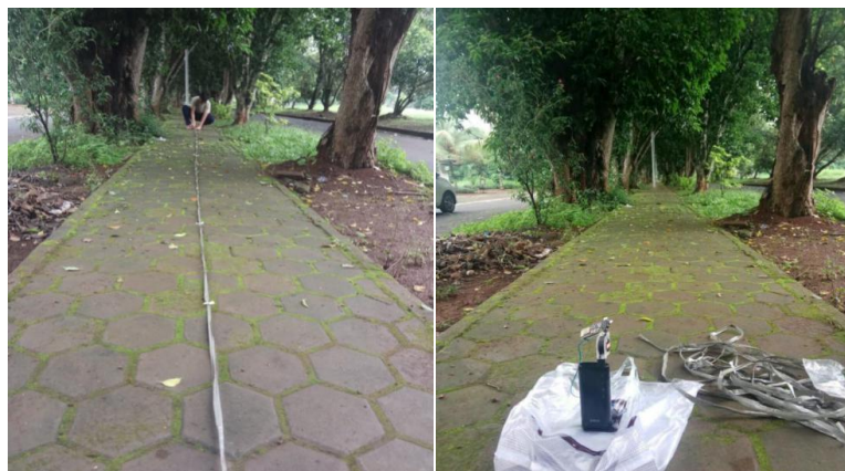
Gambar 5. Uji coba kemampuan jarak handphone dalam mengendalikan robot APPKIRA
