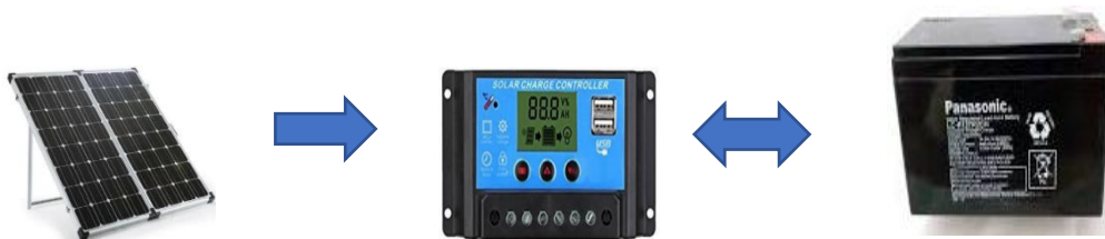
Gambar 3. Konsep peta sumber listrik yang dipasang dalam robot APPKIRA
